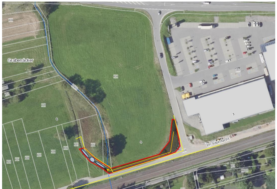
Abbildung 11: Überblick über die Schutzmaßnahmen für Eidechsen. Vorgezogene Ausgleichshabitate als schwarz-weiße Punkte angelegt. Vergrämbungsbereiche schwarz hinterlegt. Die roten Linien rund um die Vergrämbungsbereiche entsprechen der Zaunführung während der Vergrämbungszeit. Vergrämbungsrichtung als oranger Pfeil eingezeichnet. Nach erfolgreicher Vergrämbung muss der Schutzzaun zur Verhinderung der Rückwanderung sowie der Einwanderung von Süden her (gelbe Linie) errichtet werden.
